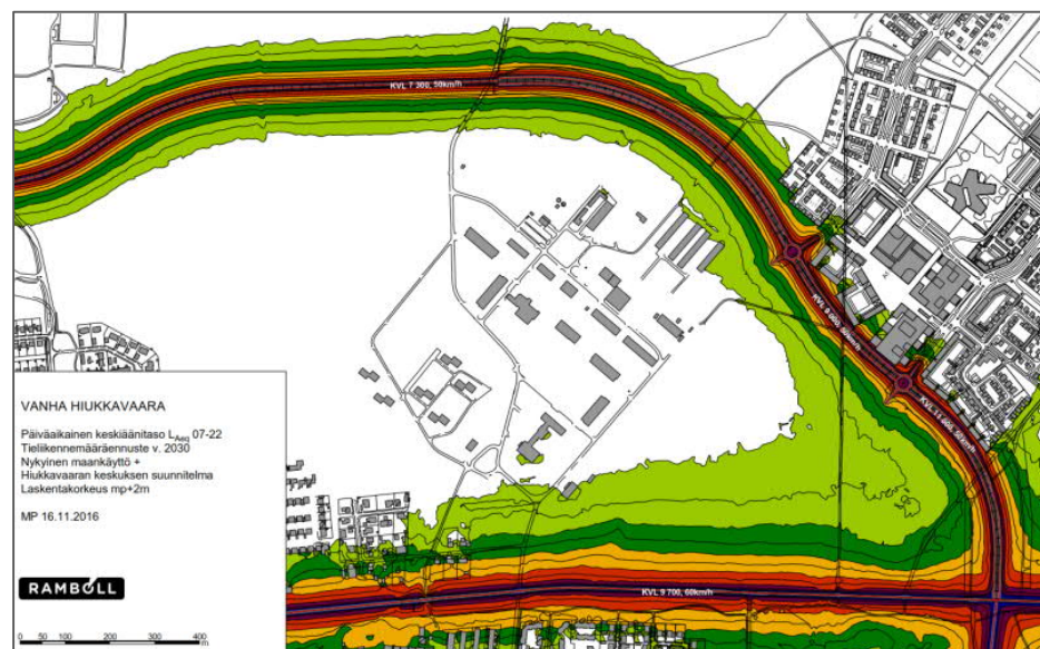
Kuva 69: Hiukkavaaran tarkistettu melumallinnus 18.11.2016 Päiväaikainen keskiäänitaso.
